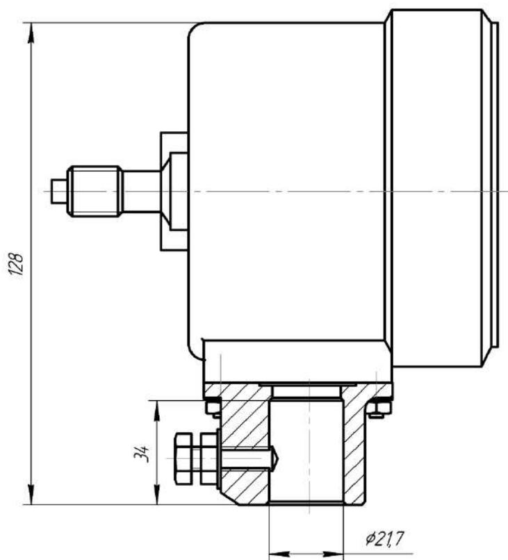
Рисунок А.2 – Габаритные и присоединительные размеры
